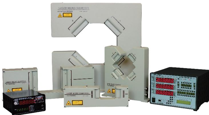
被測定物によってレーザー光が遮断された時間を長さに換算し、外径測定を行う測定器。LDMシリーズでは、使用用途に応じて検出器と表示器を組み合わせて使用する。
